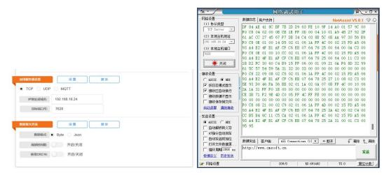
(9) 如果需要使用 MQTT,则自行搭建 MQTT 服务器,填写对应的 MQTT 节点地址以及相关订阅主题,如下图:
