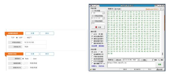
(7) 配置成功后, Net Assist 会接收来自网关的数据。可以根据蓝牙网关数据协议对数据进行解析;
